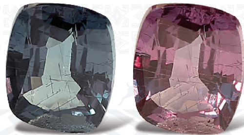
1. ábra. Alexandrit effektus: jelentős színkülönbség a napfény ekvivalens fluoreszcens lámpa (balról) és az izzó lámpa (jobbról) alatt. A kő tömege 0,78 ct, mérete 5,97 x 4,68 x 2,77 mm. A kő természetes származását a jól látható, rendezett rutiltűk igazolják.
