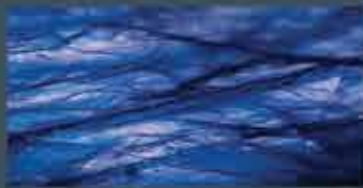
Kobalttartalmú ólomüveggel való feltöltés szintelen zafírban, mikroszkóppal, sötét látóterrel jól lehet látni a buborékokat és a kobaltüveg felhalmozódását
