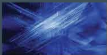
Krisztallográfiailag rendezett rutílpor (apró méretű rutíl tűk) kezeletlen Sri Lanka-i zafírban
