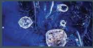
Pirop-amaldin-grosszular zárványok nagyon gyakoriak a Yogo Gulch-i (Montana) zafíroknak és valószínűsíthető az előkelő származást
