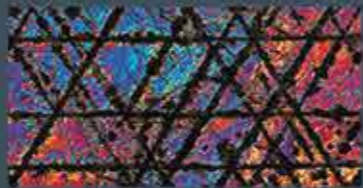
Differenciált interferencia kontraszt mikroszkópia izgalmas mintázatot fed fel: feloldódást az ikresedési síkok mentén
