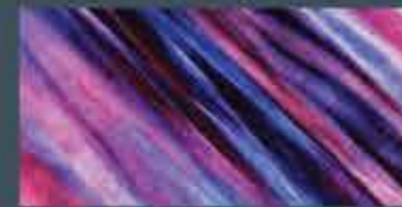
Párhuzamosan a kristály főtengelyével keresztet polárizációs szűrőkkel látható növekedési morfológia cseppolvasztásos (Verneuil-) zafírban
